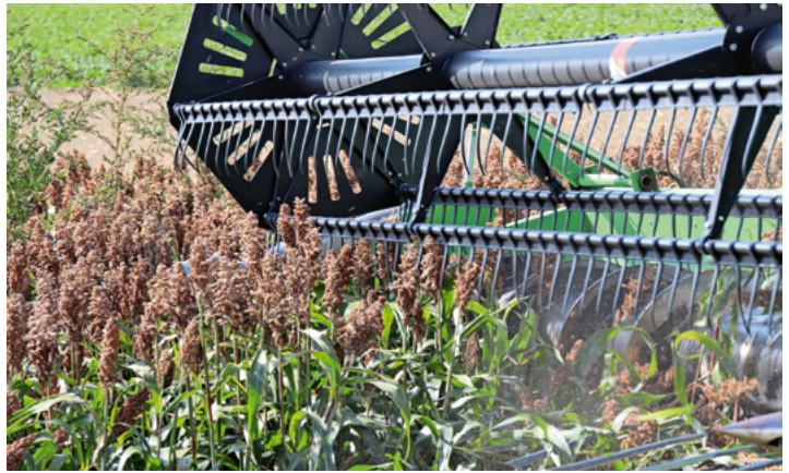
Die Schnitthöhe ist so eingestellt, dass möglichst nur Rispen geerntet werden.
